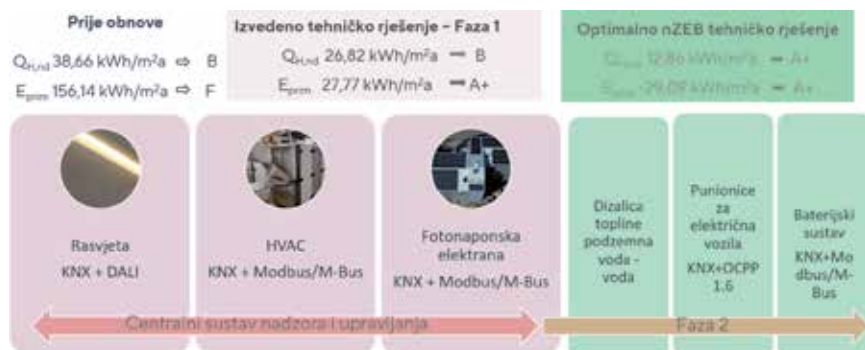
Slika 8. Shematski prikaz faza energetske obnove i ostvarenih indikatora energetske svojstva za EIHP-ovu poslovnu zgradu
